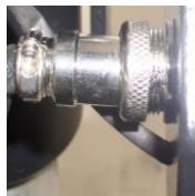
Выключите термопресс и отсоедините разъем, идущий к нагревательному элементу.
